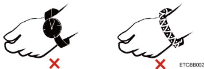
图6-2 去除易导电的物体
