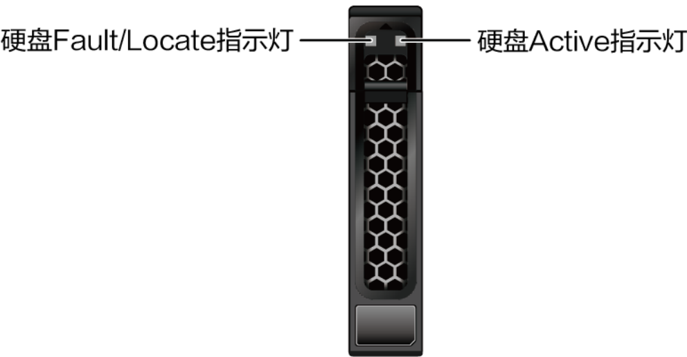
图2-9 SAS/SATA 硬盘指示灯示意图
