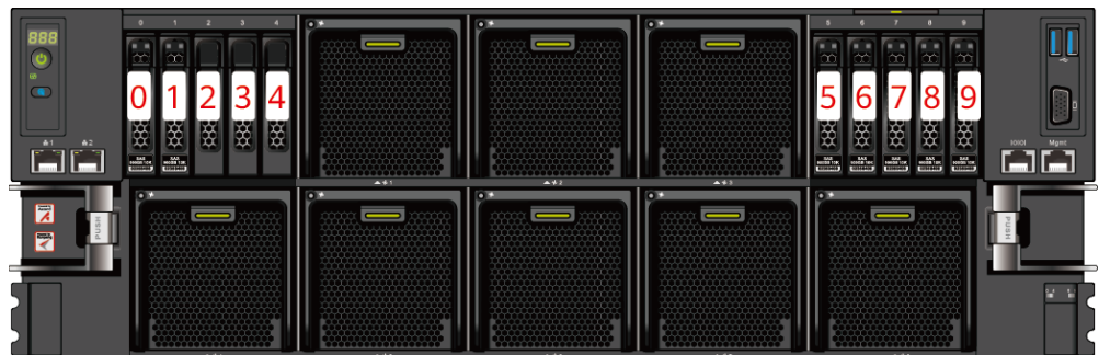
图2-8 2x2.5 SATA+5x2.5 NVMe 硬盘编号示意图
