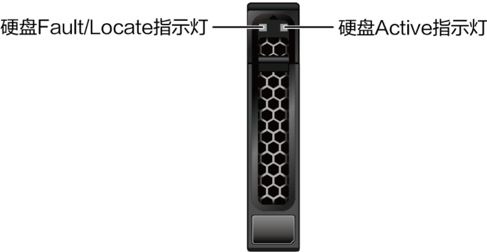
图2-10 NVMe 硬盘指示灯示意图
