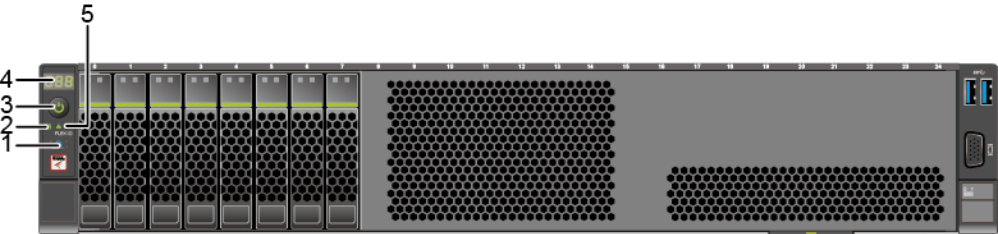
图5-3 8x2.5 英寸硬盘配置前面板指示灯和按钮
